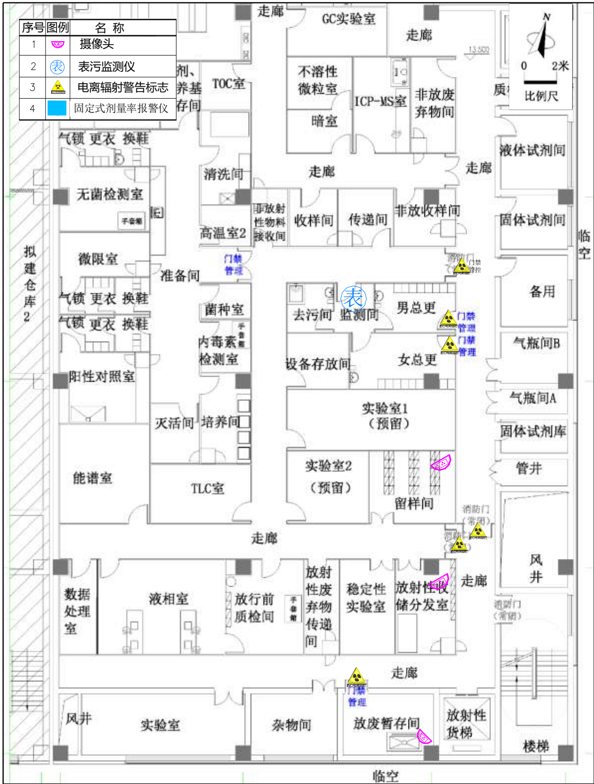
图4-29 三层非密封放射性物质工作场所安全措施布置图
